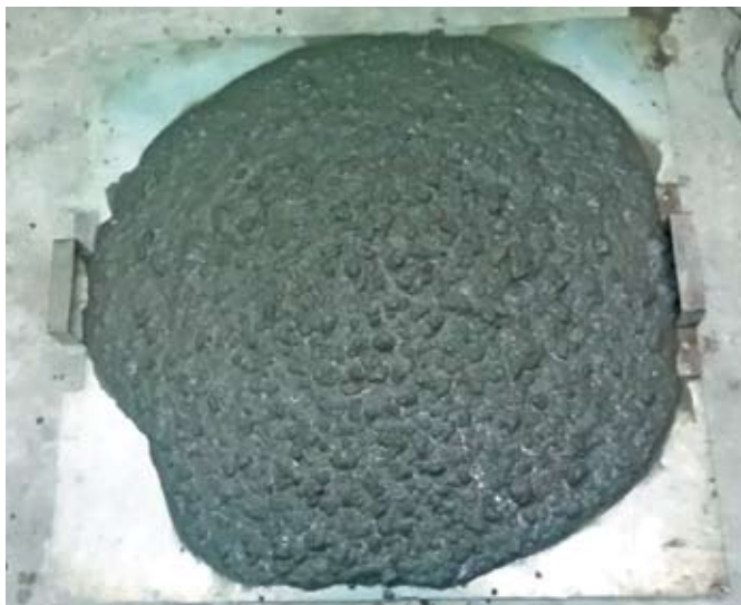
Рисунок 2. Самоуплотняющаяся бетонная смесь
