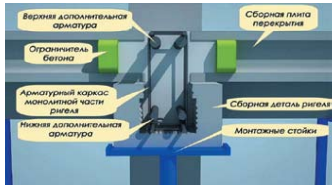
Рис. 1. Узел опирания плит перекрытия на сборно-монолитный ригель
