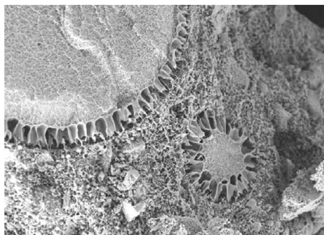
Рис. 1. Электронная криомикроскопия влажного строительного раствора через 15 минут
