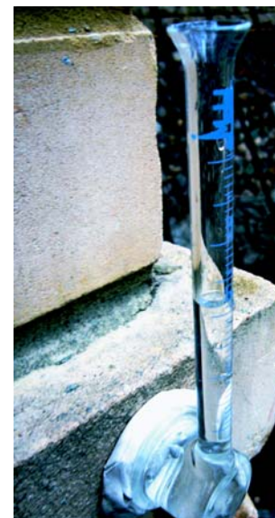
Фото 5. За два часа столбик воды в трубке Карстена понизился на 18 делений (1,8 мл)
